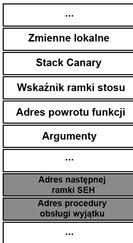
Rysunek 16. Umieszczenie rekordu SEH na ramce stosu wraz z stack canary.
